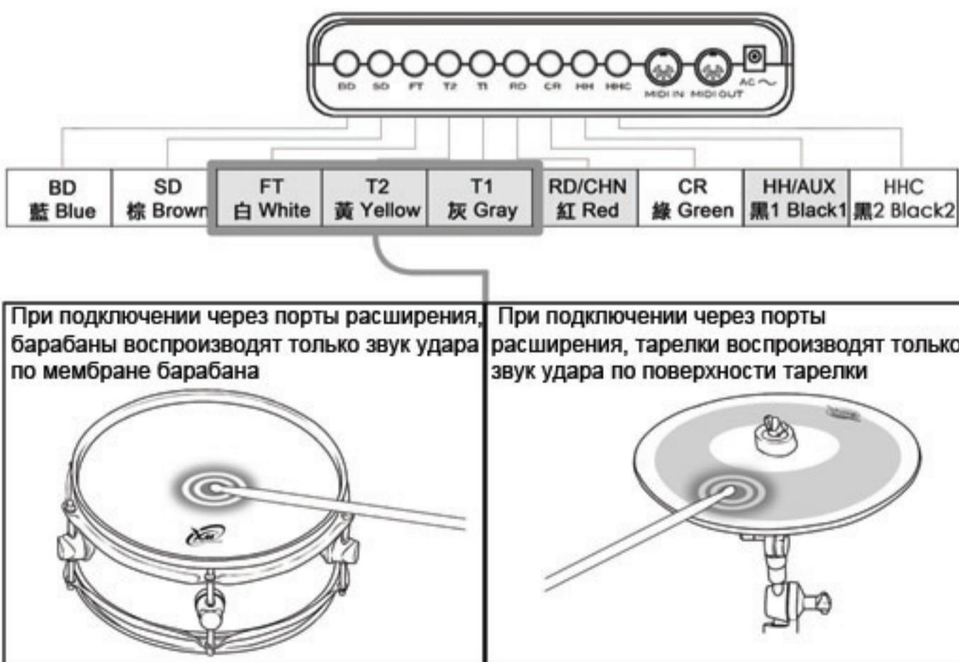
При подключении через порты расширения, барабаны воспроизводят только звук удара по мемbrane барабана
