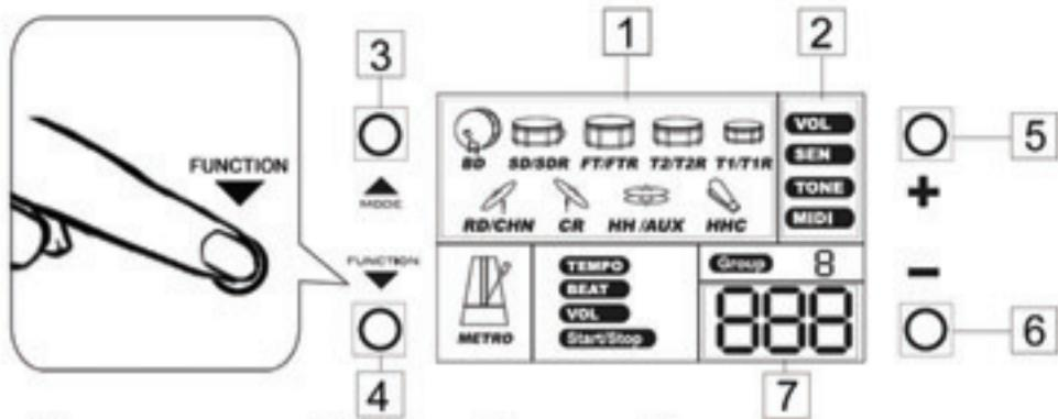
пока на изображении 2 барабанной установки не начнут одновременно мигать VOL SEN, после чего нажимайте 5 “+” или 6 “-” для настройки чувствительности центральной области тарелки. Значение чувствительности будет показано на 7 дисплее параметров. Чем выше значение, тем выше чувствительность.
