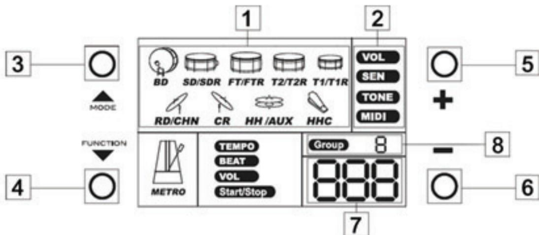
(3) После включения модуля XSM-5S, области 7 и 8 одновременно замигают, что означает, что установка находится в режиме выбора предустановленных сетов.
