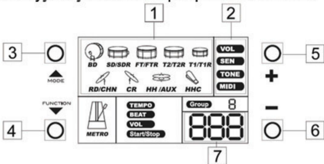
(1) Нажмите 3 кнопку “MODE”, чтобы перевести установку в режим настройки отдельных барабанов или тарелок. При этом изображение 1 барабанной установки будет мигать.
