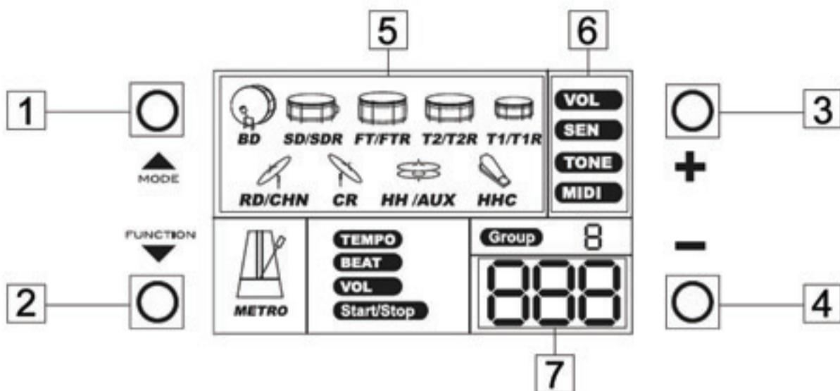
(1) Нажмите 1 кнопку “MODE”. Изображение 5 барабанной установки начнёт мигать, что означает, что включен режим настройки отдельного барабана или тарелки.
