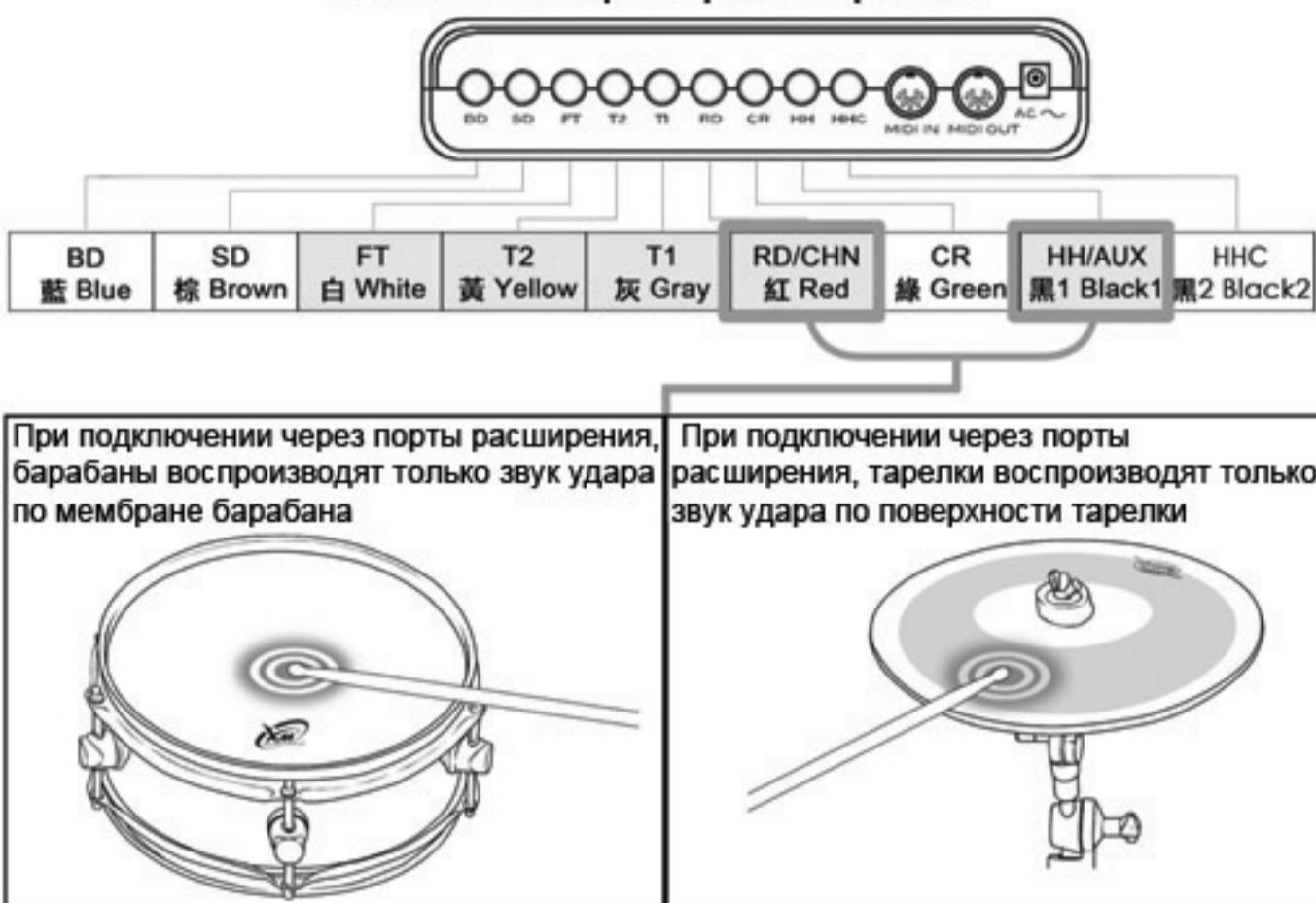
При подключении через порты расширения, барабаны воспроизводят только звук удара по мемbrane барабана
