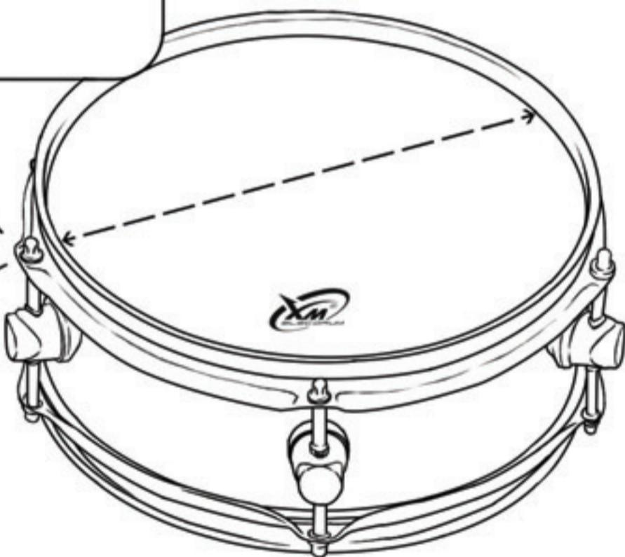
Натяжение мембранны барабана никак не влияет на тональность барабана. Натяжение используется для регулировки чувствительности удара – чем сильнее натянута мембранны барабана, тем выше будет её чувствительность.
